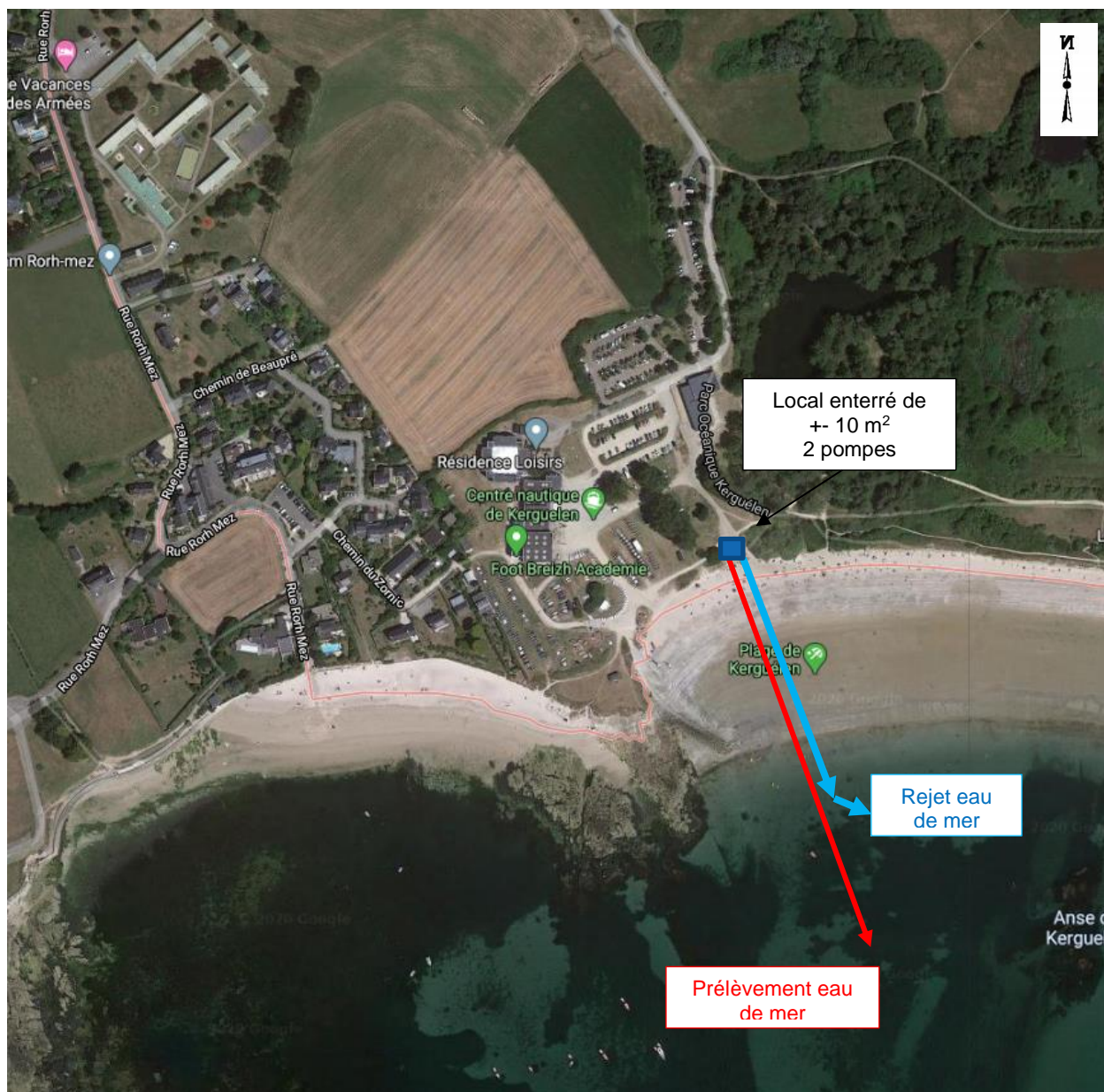
Figure 7 : Schéma d'implantation du réseau pour les prélèvements et les rejets en mer (Source : Géoportail et annotations BURGEAP)
